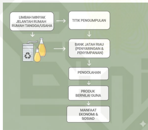
Gambar 1. 1 Mekanisme Pengumpulan Sampai Hasil Jadi Limbah Minyak Jelantah
