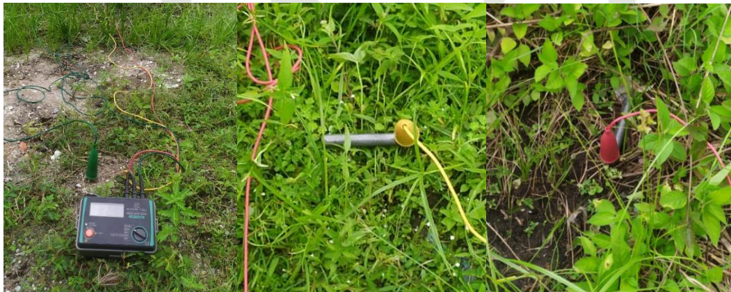
Gambar 4.3 Rangkaian Earth Tester
