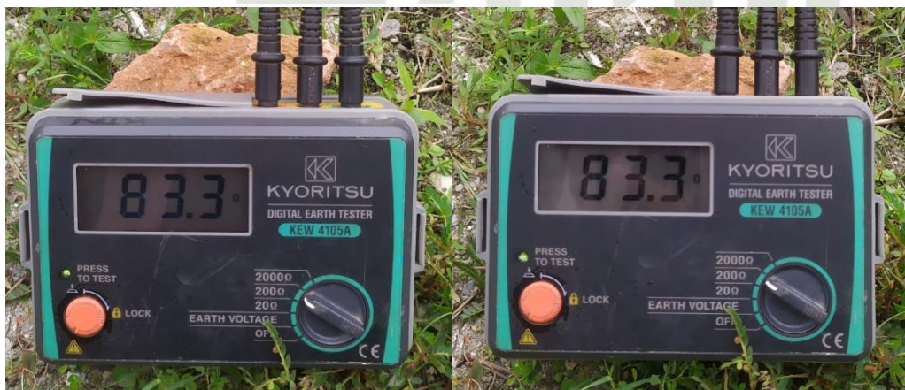
Gambar 4.12 Hasil Pengukuran Resistansi Pentanahan Sebelum Soil Treatment Pada Kondisi Kering
