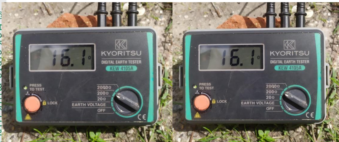
Gambar 4.11 Hasil Pengukuran Resistansi Pentanahan Sesudah Soil Treatment Pada Kondisi Basah
