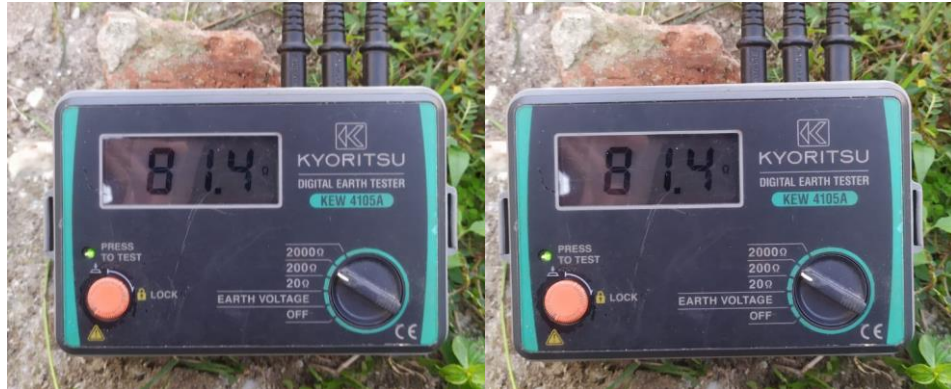
Gambar 4.5 Hasil Pengukuran Resistansi Sistem Pentanahan Pada Kondisi Eksisting
