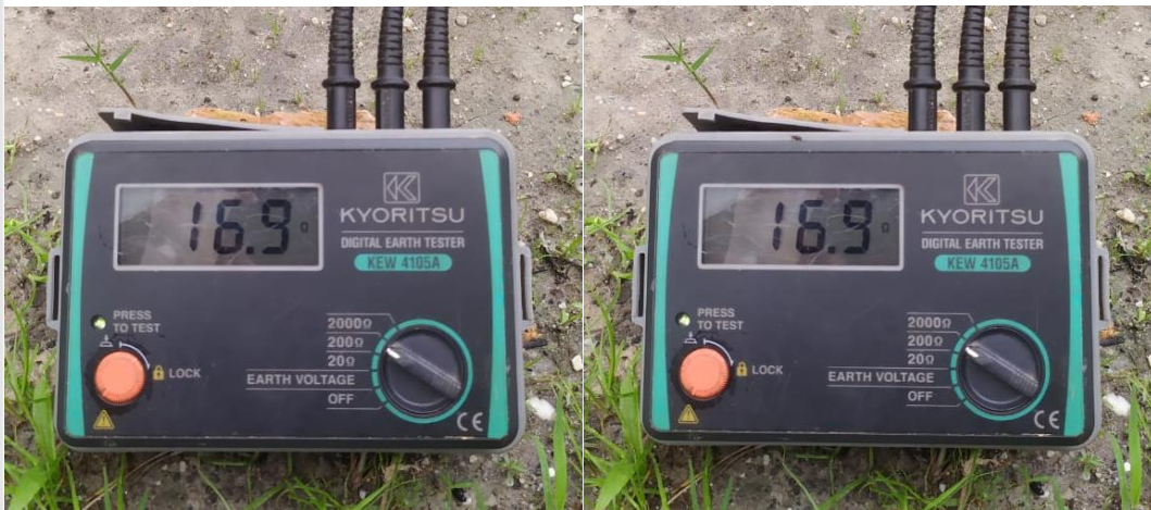
Gambar 4.13 Hasil Pengukuran Resistansi Pentanahan Sesudah Soil Treatment Pada Kondisi kering
