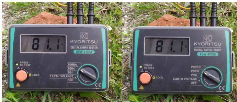
Gambar 4.7 Hasil Pengukuran Resistansi Pentanahan Sebelum Soil Treatment Pada Kondisi Basah
