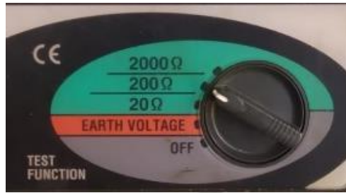
Gambar 4.4 Selektor Earth Tester
