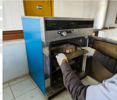
Pengovenan Sampel dengan Cawan Crusibel
