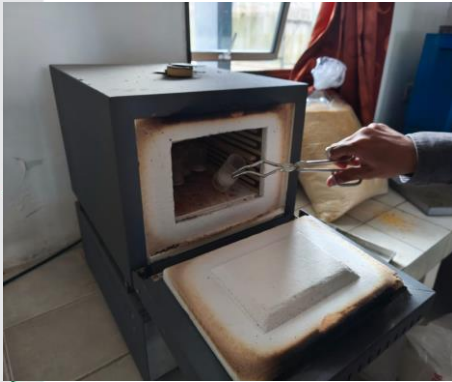
Peletakan Sampel di Tanur Pengabuan
