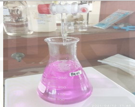
Proses titrasi dengan larutan HCl 0.5 N, dengan titik akhir titrasi berwarna merah muda
