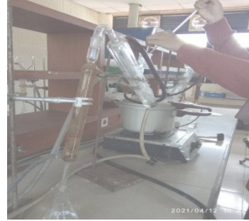
Alat destilasi markam
