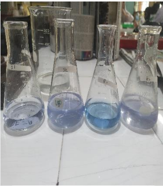
Proses titrasi iodimetri menggunakan larutan indikator pati
