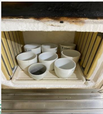
Proses pengabuan didalam tanur dengan suhu 600 °C
