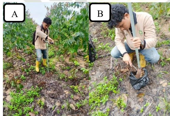
Gambar 3.2 Pengambilan Sampel Tanah (A) Melakukan Pengeboran Tanah, (B) Mengambil Sampel dan Dikomposit.
