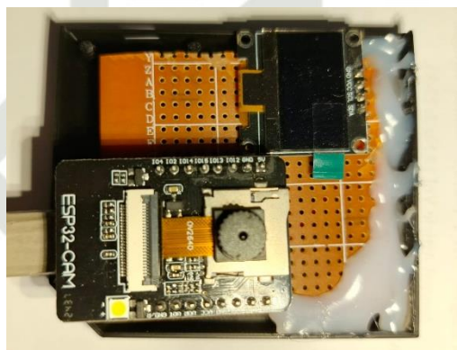
Gambar 3. 10 Rangkaian PCB menggunakan ESP32-CAM dan OLED
