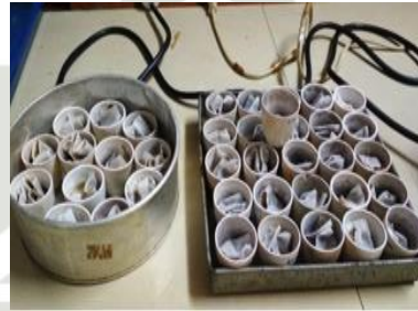
25. Pengovenan Residu Hasil Saringan dengan Suhu 105°C untuk Uji Protein Kasar
