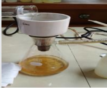
22. Penanganan Sampel Setelah 48 jam diinkubasi dengan larutan pepsin
