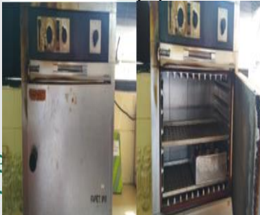
26. Pengovenan Residu Hasil Saringan dengan Suhu 105°C untuk Uji Protein Kasar
