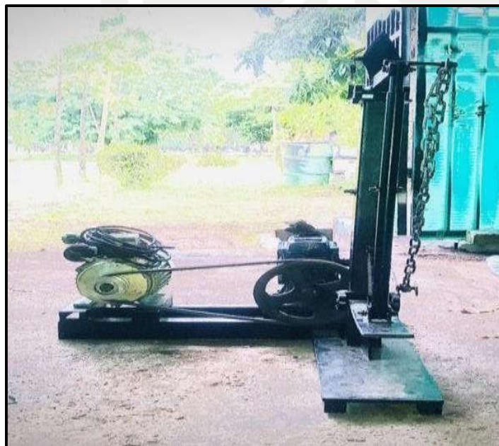
Gambar 1.2 Mesin pengupas sabut kelapa (Sumber :Muhammad Nabil, 2023)
