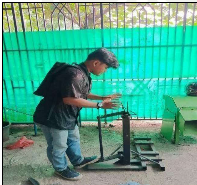
Gambar 1.3 Pengujian pengupas sabut kelapa (Sumber :Muhammad Nabil, 2023).
