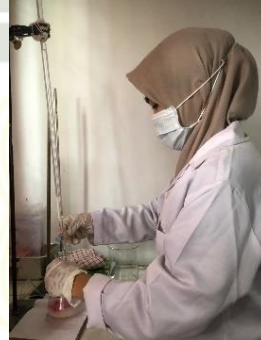
Titrasi dengan NaOH
