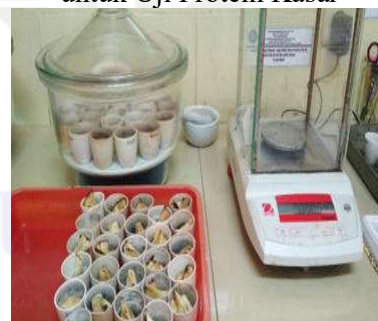
Gambar 21. Pengabuan Sampel untuk Menentukan KcBO
