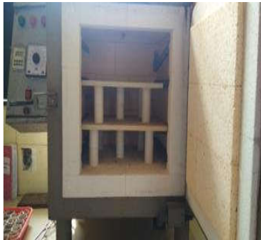
Gambar 22. Pengabuan Sampel untuk Menentukan KcBO
