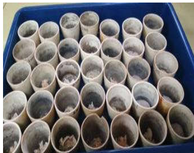
Gambar 24. Pengabuan Sampel untuk Menentukan KcBO
