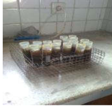
Gambar 15. Proses Uji Kecernaan Pascainkubasi Selama 48 Jam
