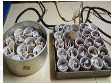
Gambar 19. Pengovenan Residu Hasil Saringan dengan Suhu 105°C untuk Uji Protein Kasar
