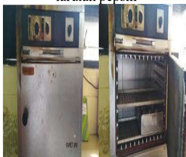
Gambar 20. Pengovenan Residu Hasil Saringan dengan Suhu 105°C untuk Uji Protein Kasar
