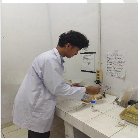
Penimbangan 10 gr Sampel Tanah untuk Penetapan pH Tanah
