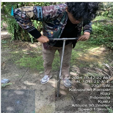
Pengambilan Sampel Tanah dengan Bor Tanah Mineral
