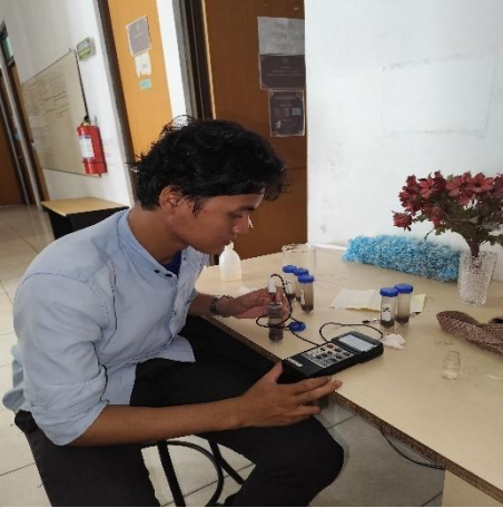
Pengukuran pH Tanah Menggunakan pH Meter
