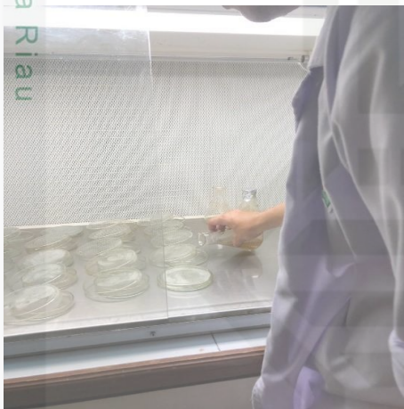
PDA dan ekstrak kulit jengkol di tuangkan ke masing-masing cawan Petridis sesuai perlakuan
