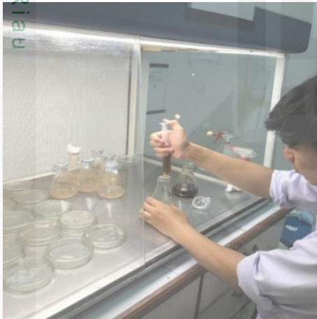
Ekstrak kulit jengkol disterilkan dengan membrane filter.
