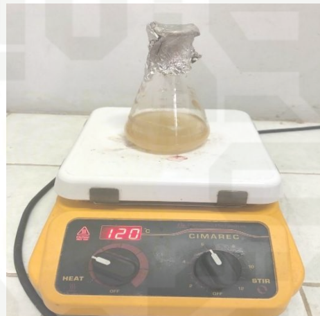
PDA dihomogenkan menggunakan hot plate with magnetic stirrer
