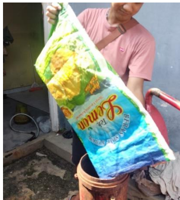
Cangkang kelapa sawit dimasukkan ke dalam tabung pirolisator
