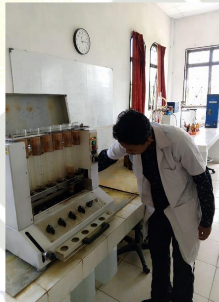
Sampel dimasukkan ke alat fibertex hot extraction
