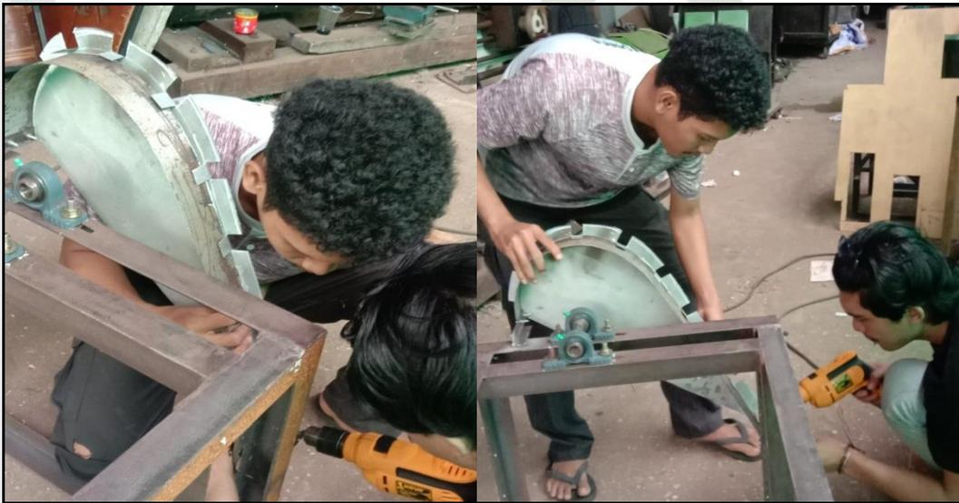
Gambar 4.12 Dokumentasi Pembuatan *Cover* Penutup *Pulley*
