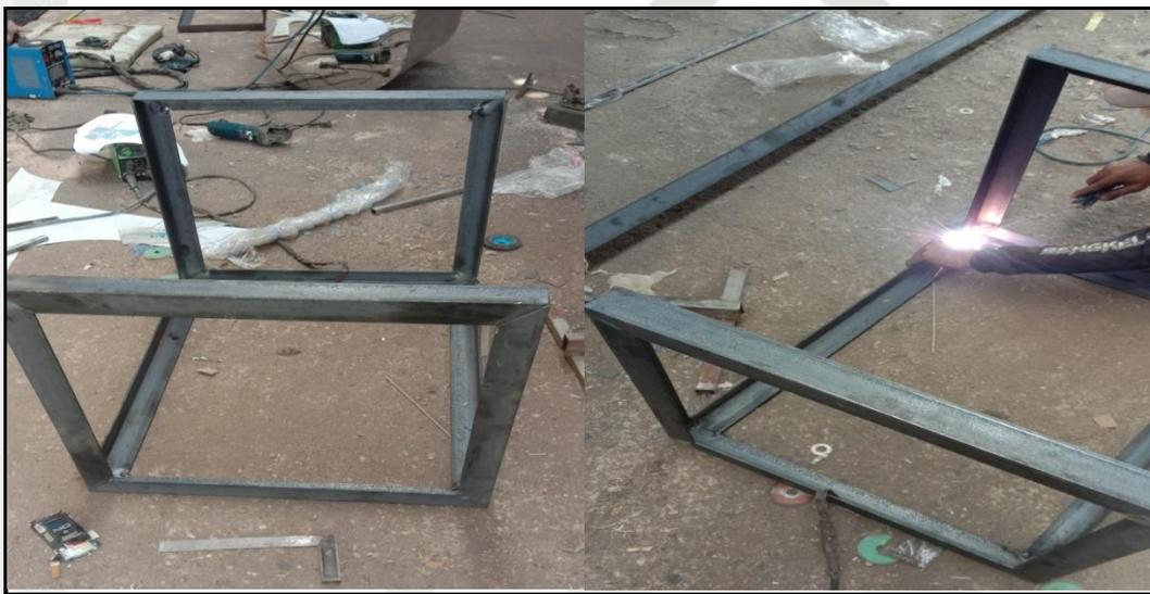
Gambar 4.8 Dokumentasi Pembuatan Rangka
