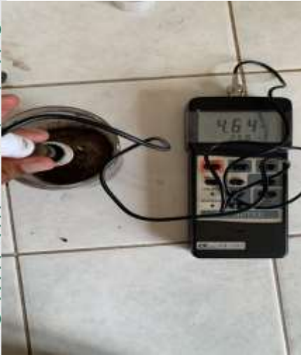
Pengukuran pH Tanah Sampel
