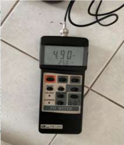
Pengecekan pH Tanah Setelah Inkubasi
