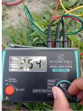
Pengukuran Nilai Resistansi Pentanahan Sebelum *Soil Treatment* Pada saat kondisi Basah
