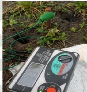
Pengukuran Nilai Resistansi Pentanahan Setelah *Soil Treatment* Pada saat kondisi Basah
