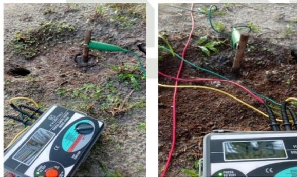
Pengukuran Nilai Resistansi Pentanahan Sebelum *Soil Treatment* Pada saat kondisi Kering
