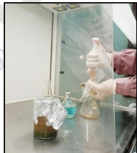
12. Sterilisasi ekstrak dengan membran filter di ruang laminar
