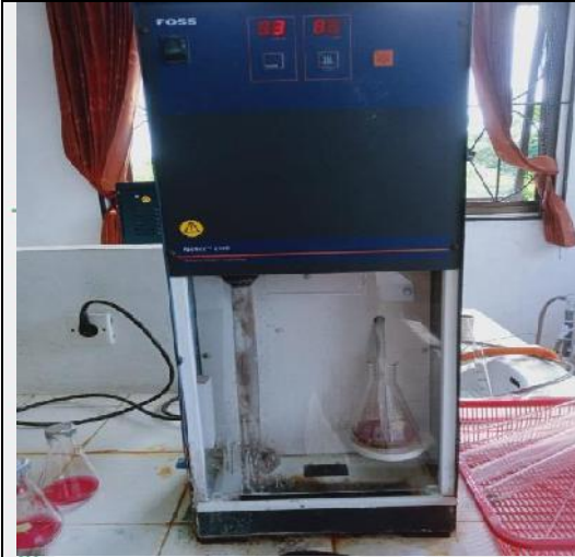
Kjeltec proses mencari kadar protein kasar
