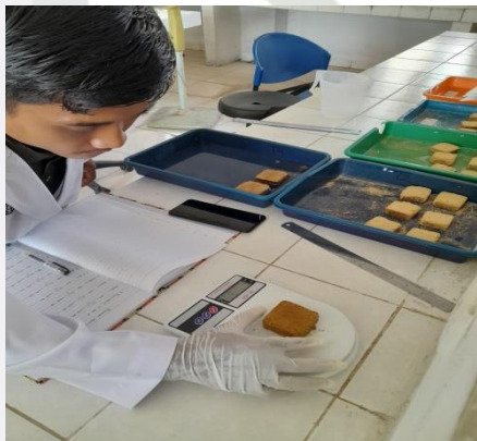
Pengujian daya serap air wafer
