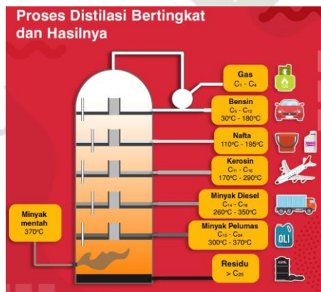
Gambar 2. 1 Destilasi Bertingkat
