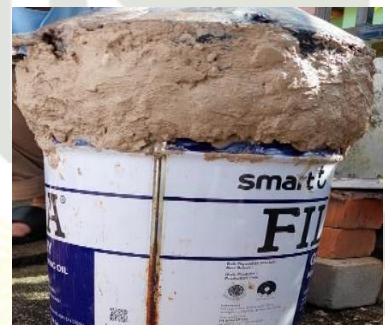
4. Tabung polisorator ditutup dengan tanah liat
