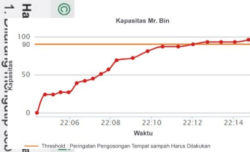
Gambar 7. Grafik Hasil Pengujian Fungsionalitas Sensor Ultrasonik
