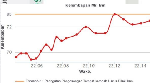
Gambar 8. Grafik Hasil Pengujian Fungsionalitas Sensor DHT22
