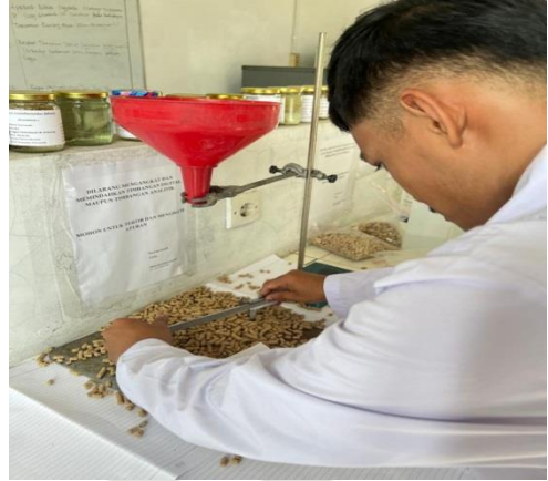
2. Uji Sudut Tumpukan
