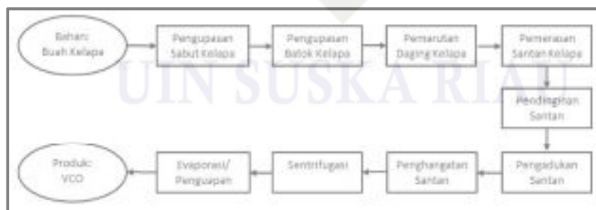
Gambar 2.3 Alur Pembuatan VCO (Sumber: Yadi, dkk., 2018)
