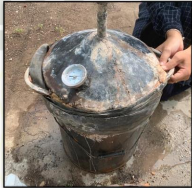
4. Penutupan wadah pirolisator dengan rapat
