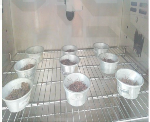
Pengovenan kompos dengan suhu 105°C selama 12 jam
