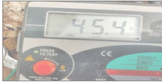
Gambar 3.5 Hasil Pengukuran Grounding Kantor Bupati 50 Kota Payakumbuh
