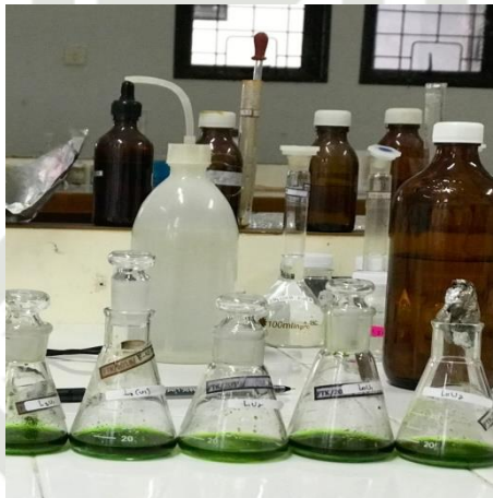
Menghomogenkan campuran Microgreen yang sudah dihaluskan dengan Larutan Aseton selama 2x 24jam
