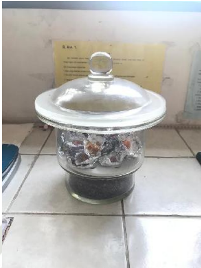
Proses pendinginan sampel kedalam desikator setelah di oven
