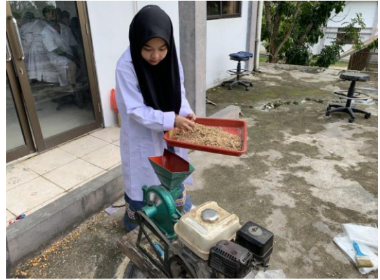
Proses penggilingan silase limbah sayur
