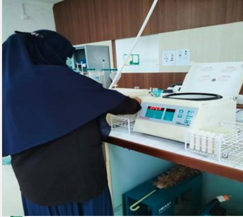
Melakukan proses sentrifugasi dengan kecepatan 5000 rpm selama 10 menit
