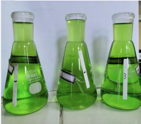
Hasil pemisahan Supernatan dari larutan homogenat yang sudah di Sentrifugasi
