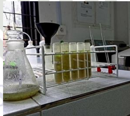
Menghomogenkan campuran Microgreen yang sudah dihaluskan dengan Larutan Buffer selama 2 jam
