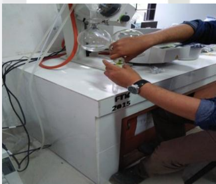
Proses pemisahan senyawa menggunakan rotary evaporasi / rotavapor pada suhu 35°C. .
