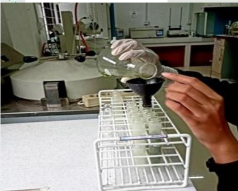
Penuangan Larutan yang sudah di Homogenkan ke dalam Tabung Reaksi untuk Proses Sentrifugasi selanjutnya
