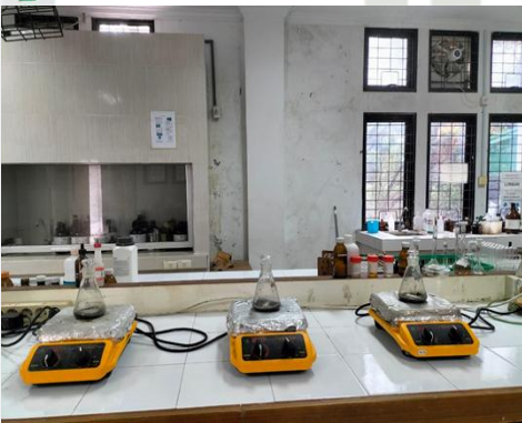
Menghomogenkan campuran Microgreen yang sudah dihaluskan dengan Larutan Buffer selama 2 jam
