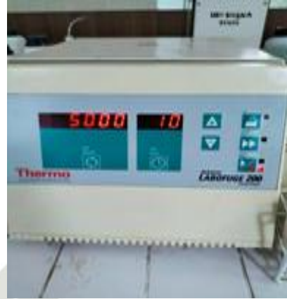
Melakukan proses sentrifugasi dengan kecepatan 5000 rpm selama 10 menit
