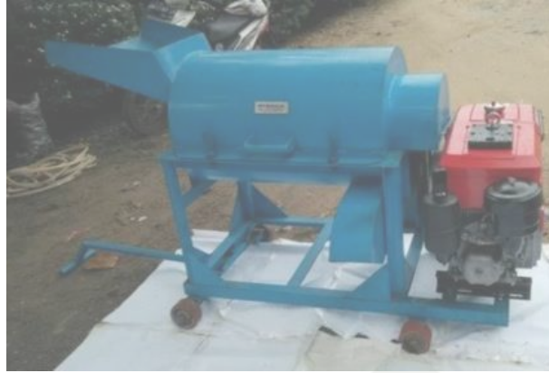
Gambar 2.13 Mesin Cacah Sumber : Dokumentasi Penelitian (2022)
