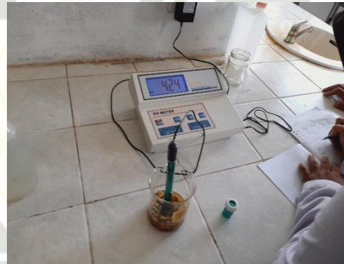
Pengukuran pH silase
