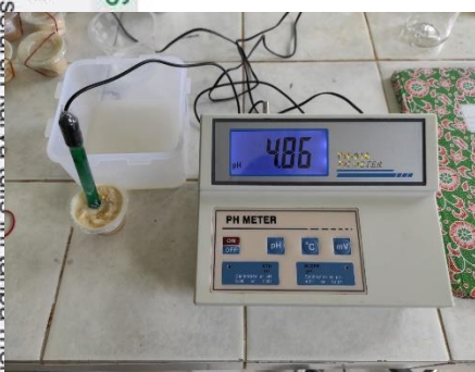
3. Pengukuran pH Dadih Susu Sapi dengan Lama Inkubasi 36 Jam Menggunakan pH Meter
