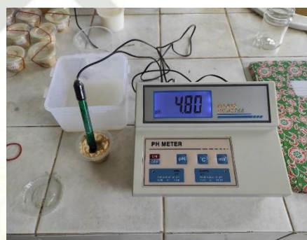
4. Pengukuran pH Dadih Susu Sapi dengan Lama Inkubasi 48 Jam Menggunakan pH Meter
