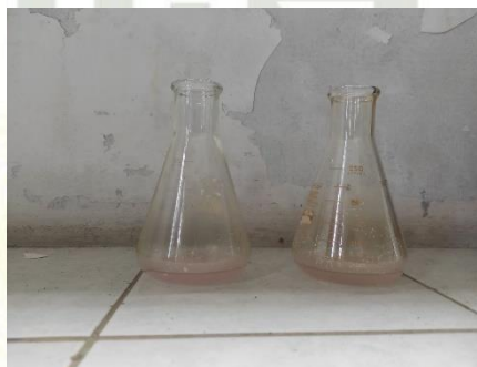
6. Titrasi sampel dengan menggunakan NaOH 0,1 hingga sampel berubah warna menjadi warna pink seulas
