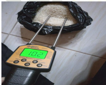
Gambar 3.9. Hasil Pengukuran Kadar Air Beras Menggunakan Grain Moisture Meter
