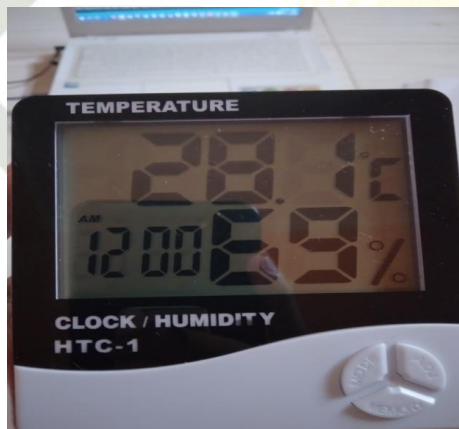
Gambar 3.8. Hasil Pengukuran Suhu dan Kelembaban Pada Termometer Digital
