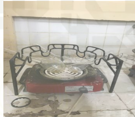
Poc di destruksi selama 1 jam
