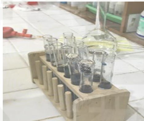
Tambahkan 10 ml pewarna P dan menutup tabung reaksi dengan aluminium foil
