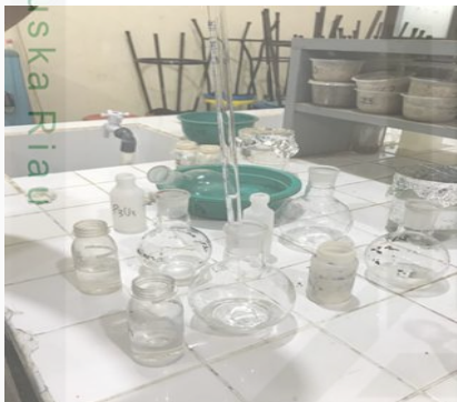
Ekstrak 10 ml, NaOH 40% 10 ml dan aquades dimasukkan ke dalam labu didih
