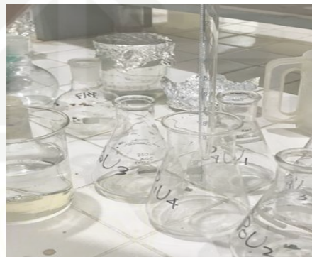
Memasukkan larutan H_3BO_3 1% sebanyak 10 ml pada erlemeyer
