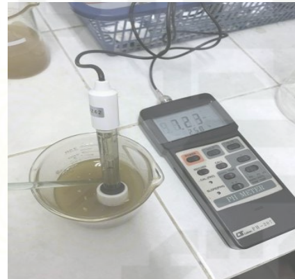
pH diukur menggunakan alat pengukur pH
