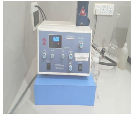
Ekstrak di ukur dengan alat flamephotometer
