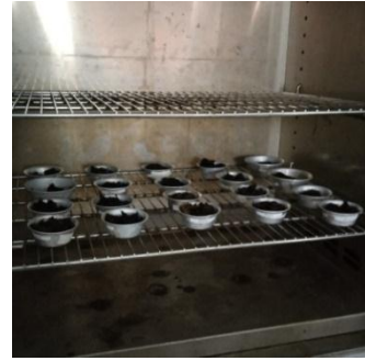
Pengovenan kompos dengan suhu 105°C selama 12 jam
