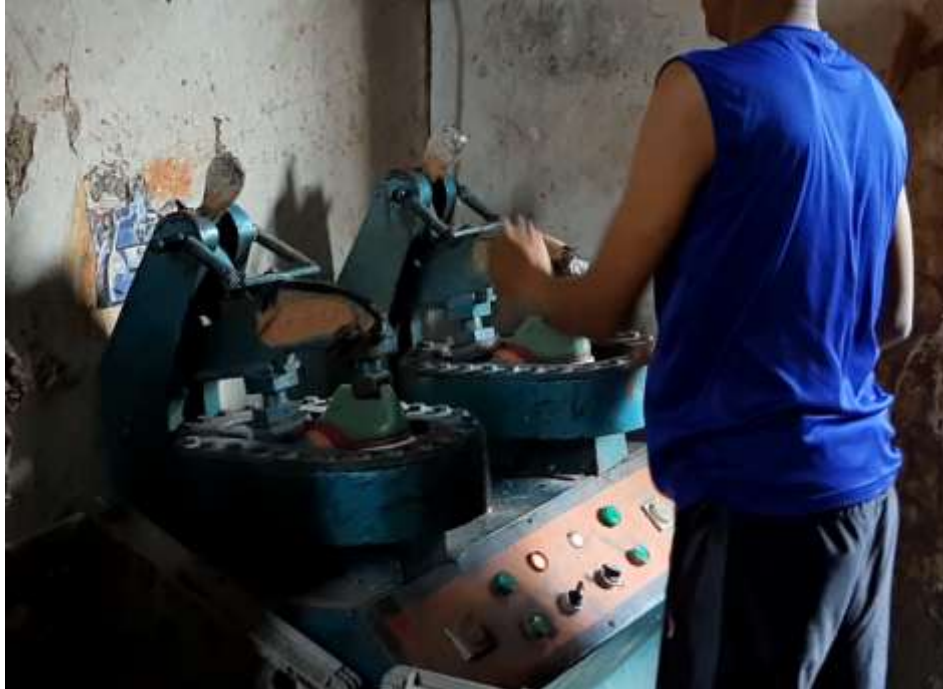
Gambar 4.22.b Stasiun Kerja Assembly/Pengepresan (Mesin Press)
