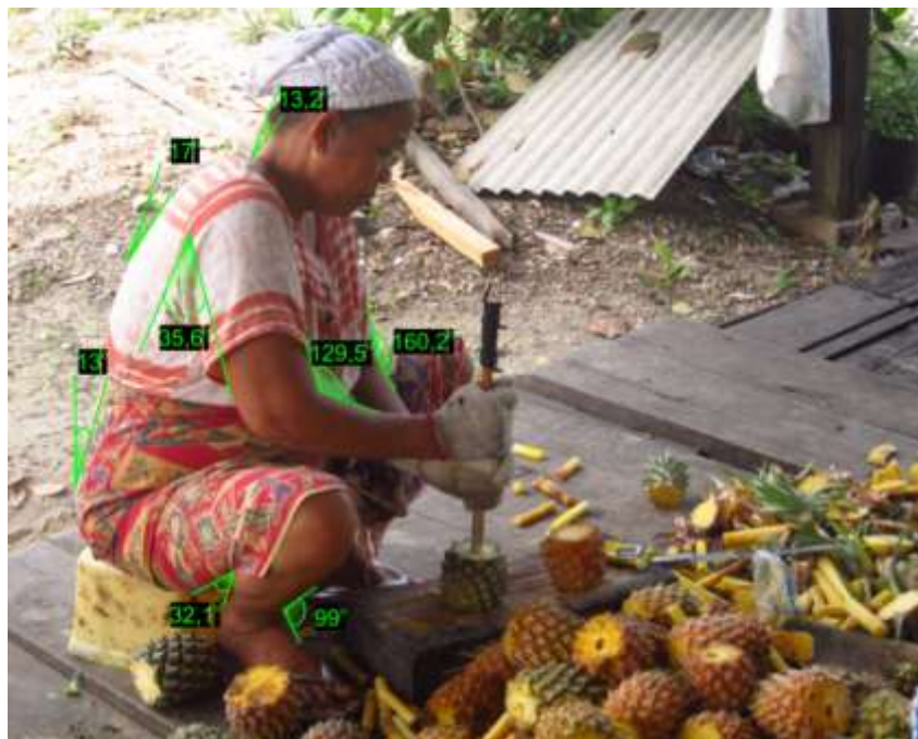
Gambar 4.9 Proses Pelubangan Nenas manual
