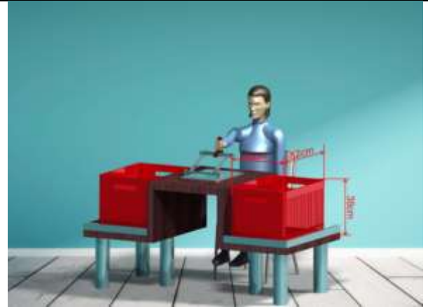
Gambar 5.4 Modifikasi Stasiun Kerja Pelubangan Nanas
