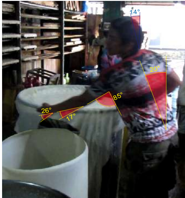
Gambar 4.21 Posisi Tubuh Pekerja saat Menyaring Bubur Kedelai Berdasarkan Gambar 4.21 dapat dilihat bahwa pekerja saat menyaring bubur kedelai, yang dilakukannya dengan posisi berdiri. Penilaian postur kerja berdasarkan Gambar 4.21 dapat dilihat pada Tabel berikut ini.
