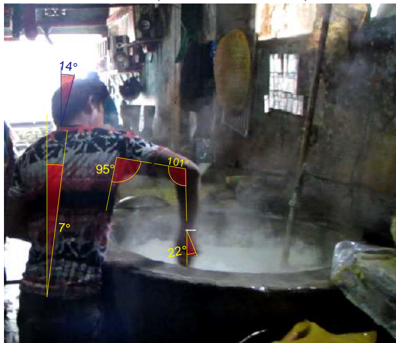
Gambar 4.20 Posisi Tubuh Pekerja saat Merebus Bubur Kedelai
