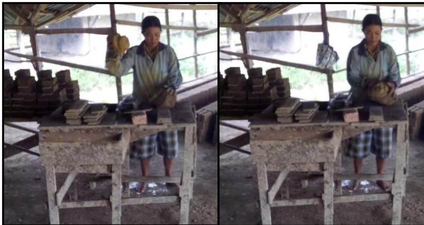
Gambar 5.3 Operator Meletakkan dan Menyatukan Bongkahan Tanah Liat
