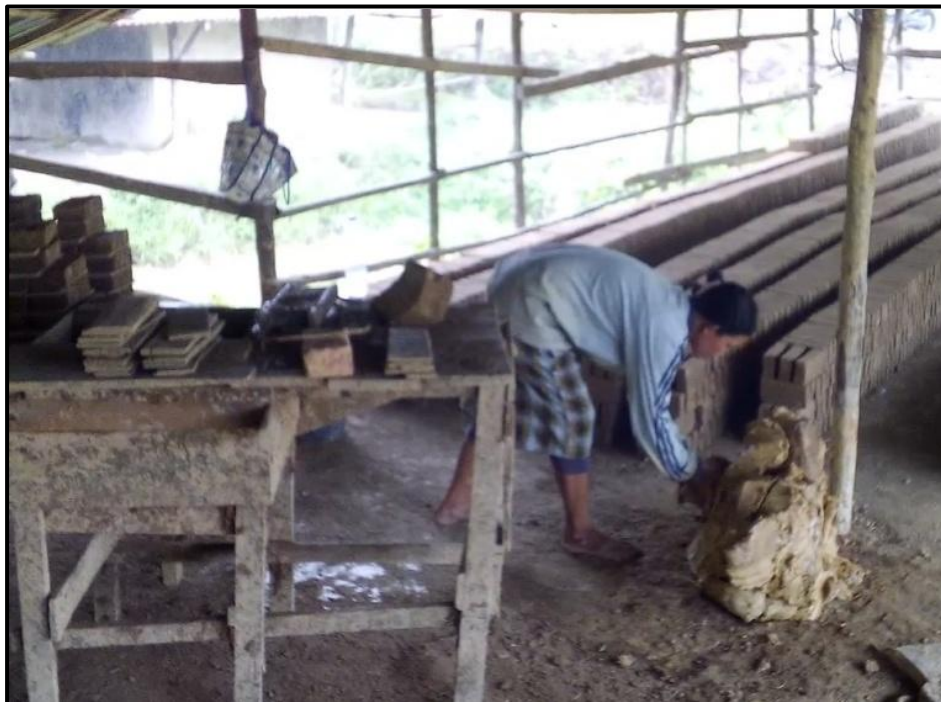
Gambar 5.1. Operator mengambil tanah liat
