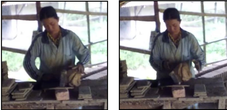
Gambar 5.8 Operator Mencetak Tanah Liat
