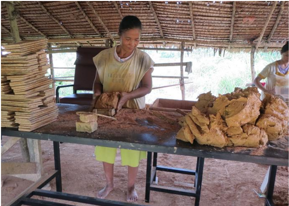
Proses Pencetakan Batu Bata di Meja Pencetakan Batu Bata Hasil Rancang Ulang
