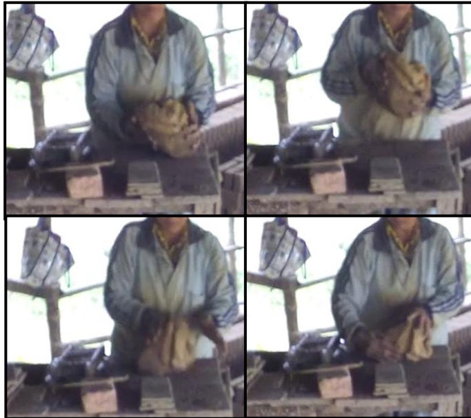
Gambar 5.4. Operator Memadatkan Bongkahan Tanah Liat Siap Cetak
