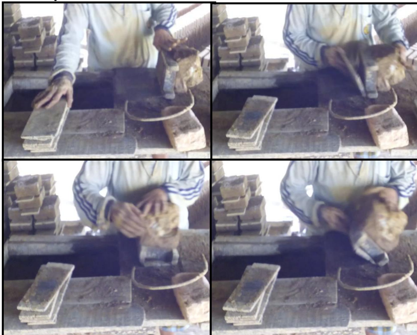
Gambar 5.9 Operator Meletakkan Papan Kecil dan Memposisikan Semula Cetakan
