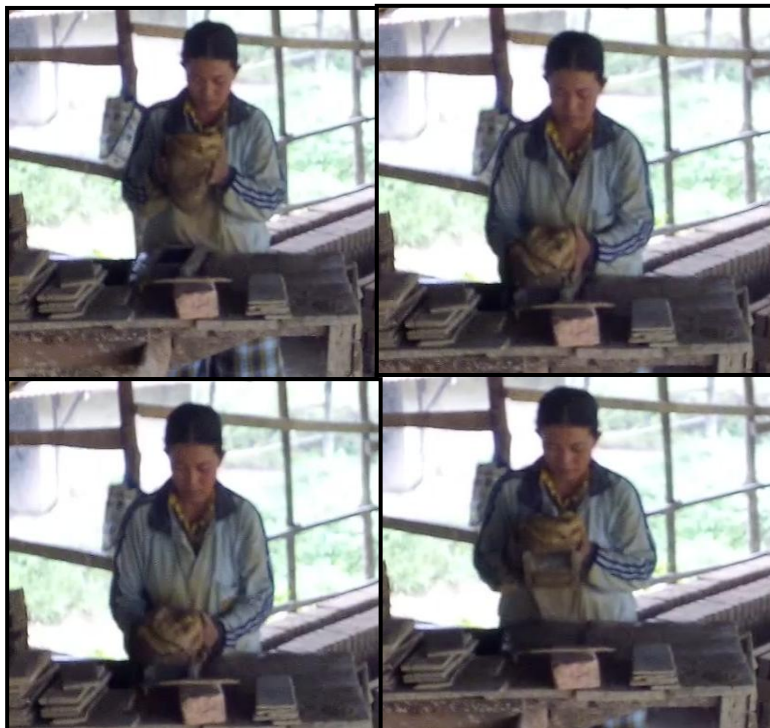
Gambar 5.7 Operator Mencetak Tanah Liat
