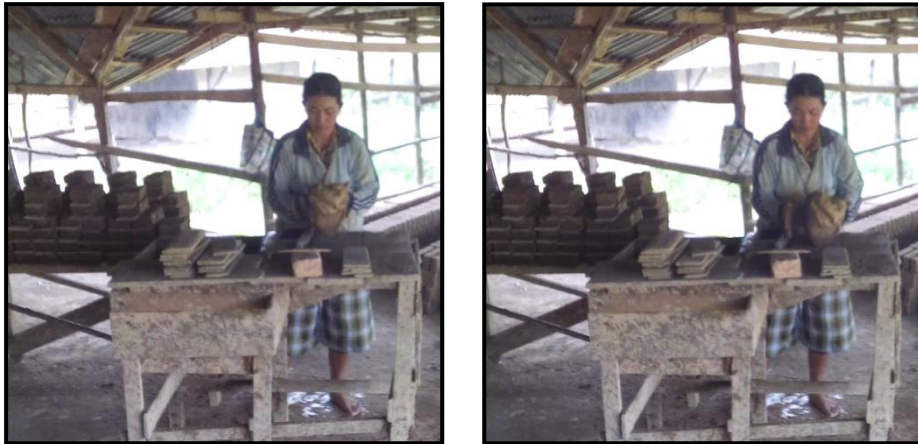
Gambar 5.6. Operator Mengambil Bongkahan Tanah Liat Siap Cetak
