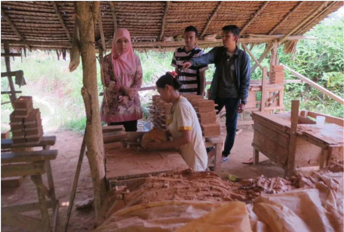
Gambar 5.37 Proses Pencetakan Batu Bata dengan Alat Lama
