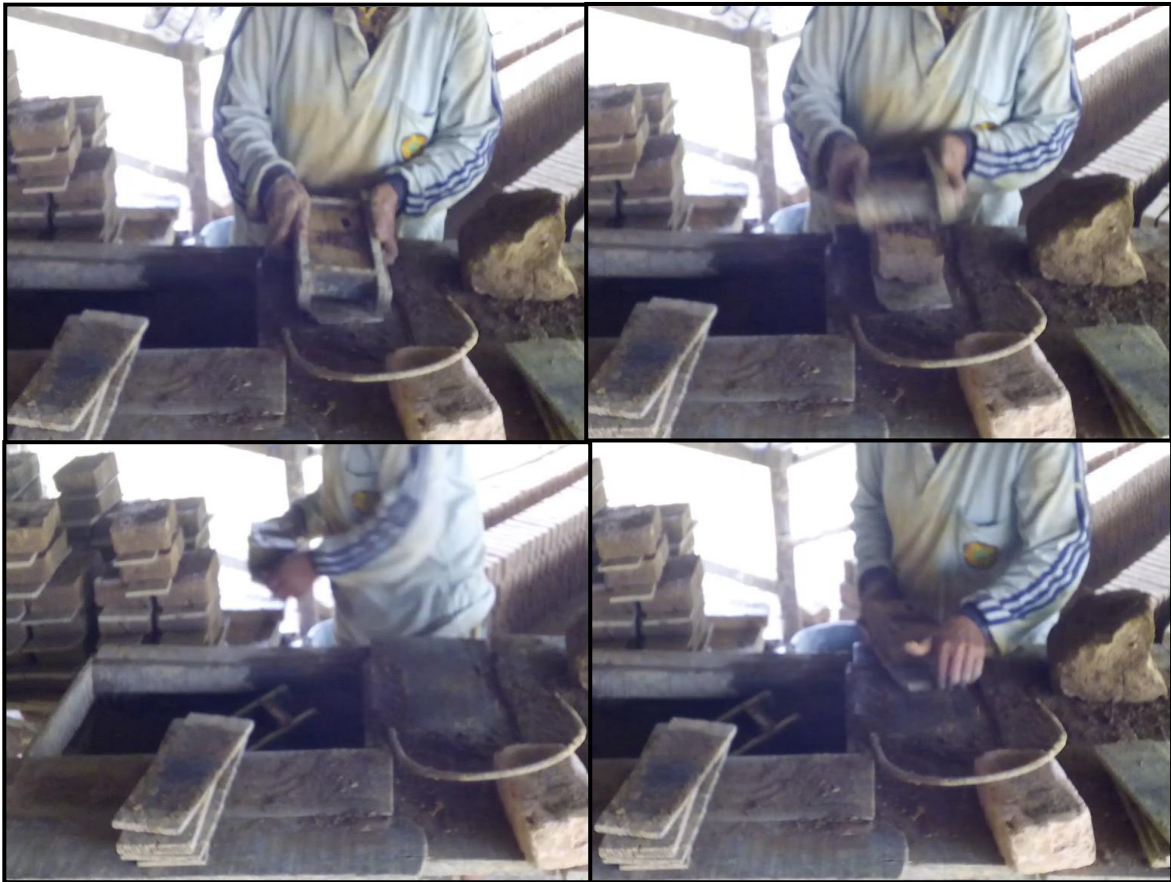
Gambar 5.11 Operator Melepaskan dan Meletakkan Setiap Hasil Cetakan Bata
