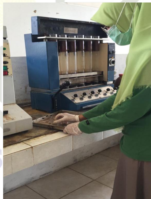
Sampel di Letakkan pada Fibertex dan diekstraksi Menggunakan Air Panas
