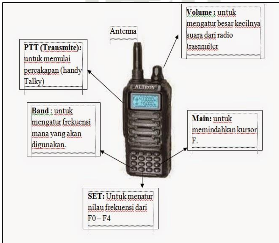
Gambar 2.4 Bentuk dan Bagian bagian Perangkat Handy Talky (HT)[22]
