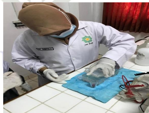
Proses memasukkan gel agarose dalam tengki elektroforesis
