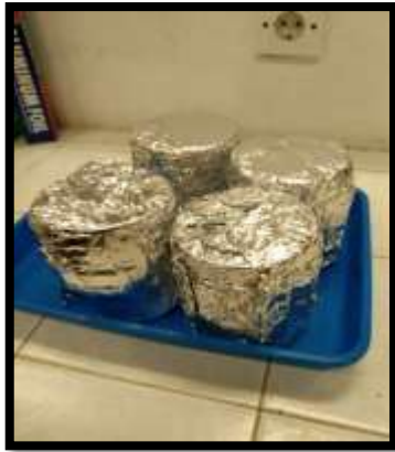
1. Bungkus cawan petri dengan alumunium foil
