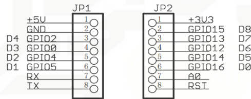
Gambar 2.3 Pin I/O Wemos D1 Mini [13]
