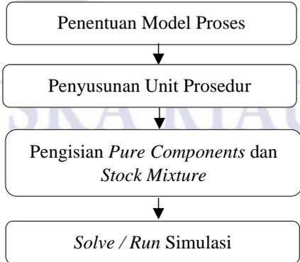
**Gambar 1.** Alur Pembuatan Bio-etanol di Aplikasi *Superpro Designer*
