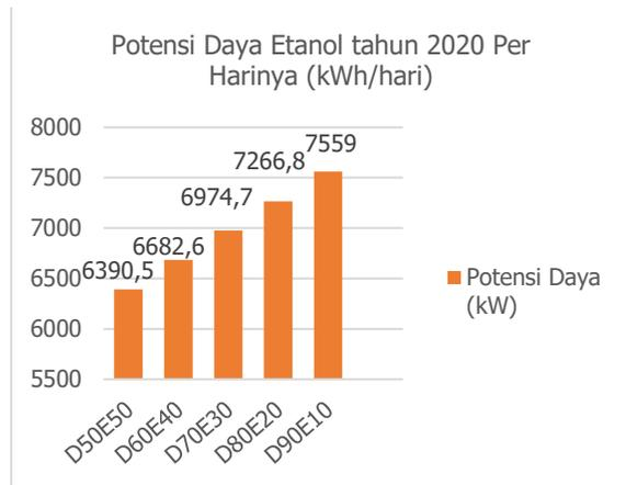
Gambar 4. Grafik Potensi Daya Etanol D50E50, D60E40, D70E30, D80E20, dan D90E10
