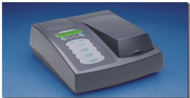
Gambar II. 7. Jenis Spektronic-20 Yang Bekerja Pada Rentang Panjang Gelombang Sinar Tampak
